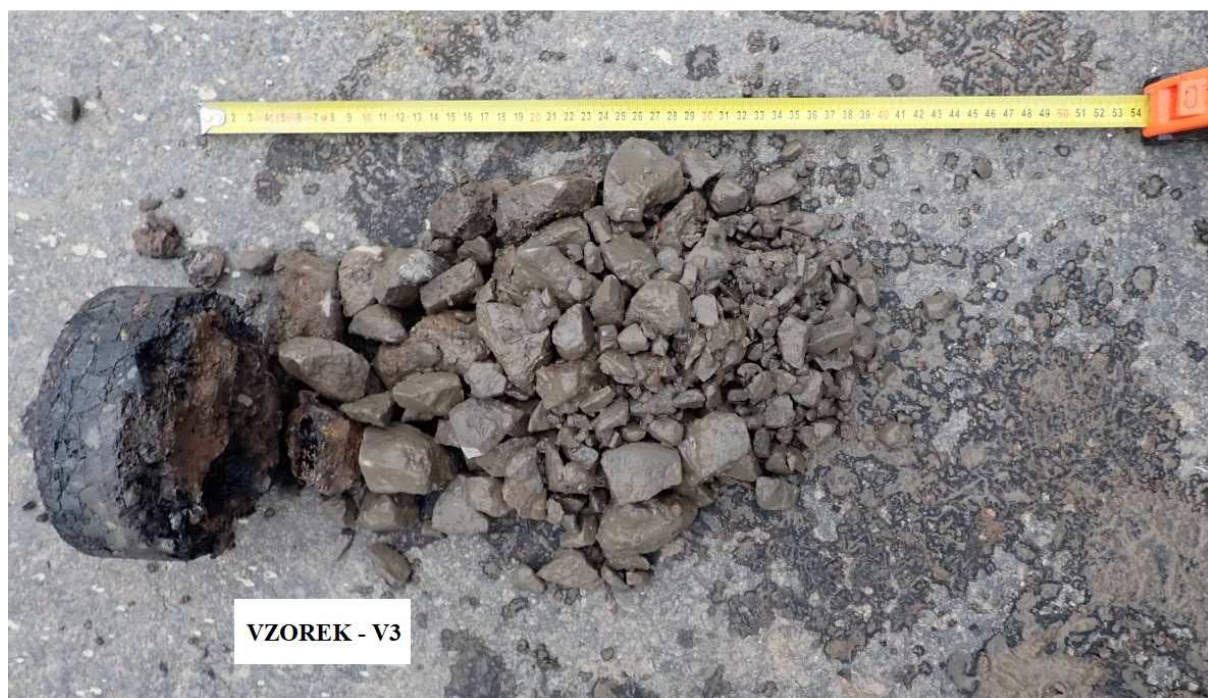
Obr. 5 - Jádro vývrtu Vzorek – V3 (in situ).
