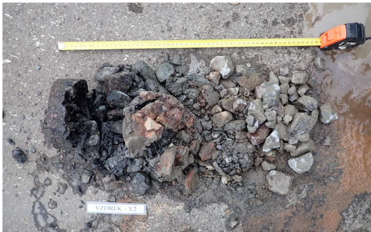
Obr. 3 - Jádro vývrtu Vzorek – V2 (in situ).
