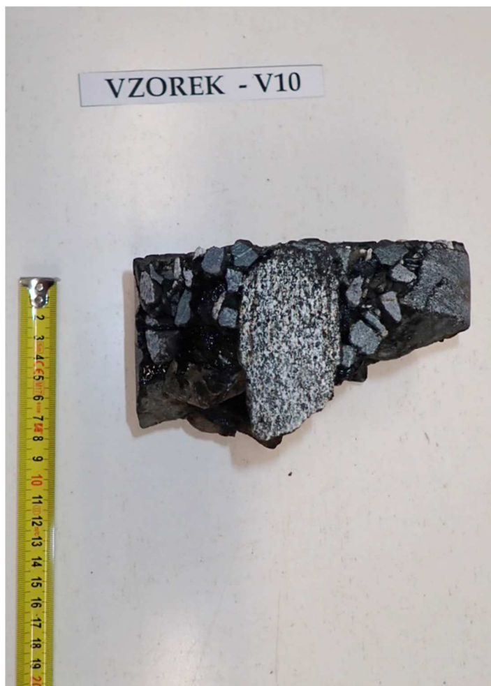
Obr. 20 - Jádru vývrtu Vzorek – V10 (laboratoř).
