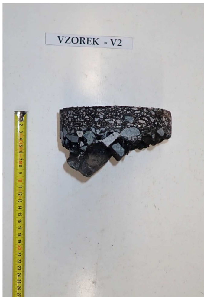
Obr. 4 - Jádru vývrtu Vzorek – V2 (laboratoř).
