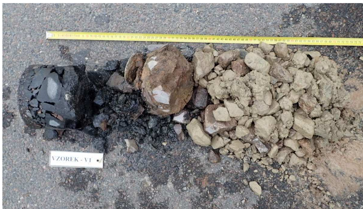
Obr. 1 - Jádro vývrtu Vzorek – V1 (in situ).
