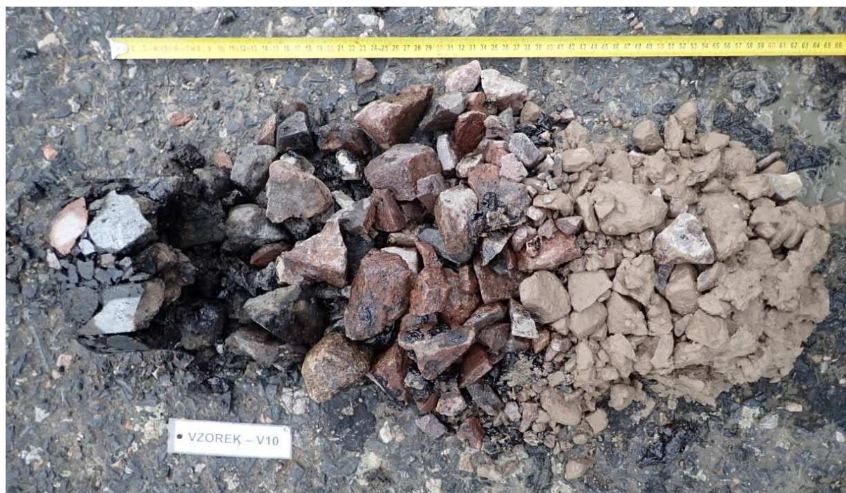
Obr. 19 - Jádro vývrtu Vzorek – V10 (in situ).
