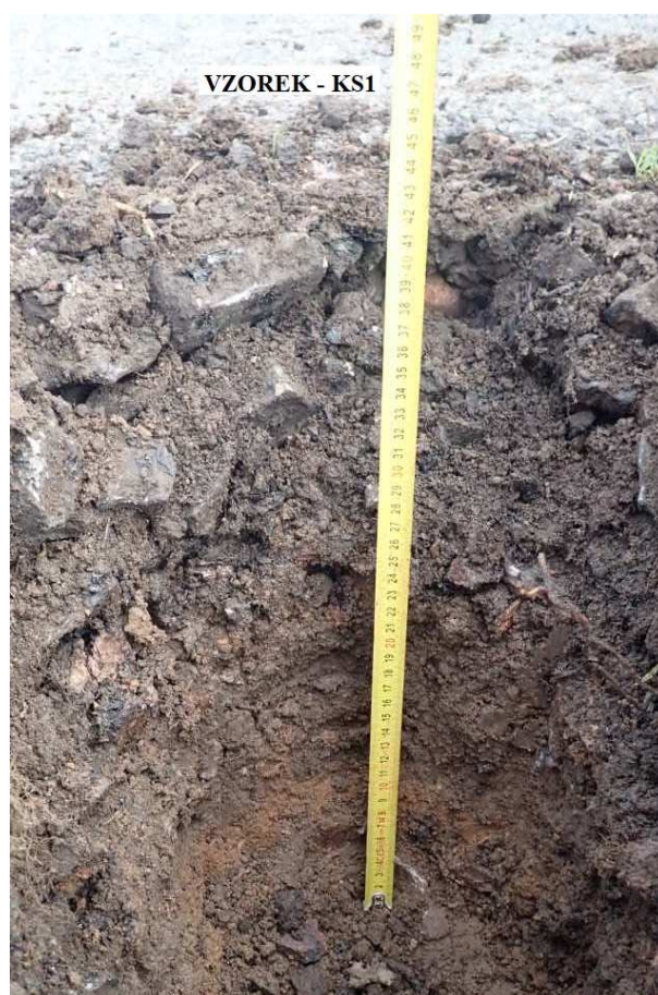
Obr. 29 - Jádro vývrtu Vzorek – KS1 (in situ).
