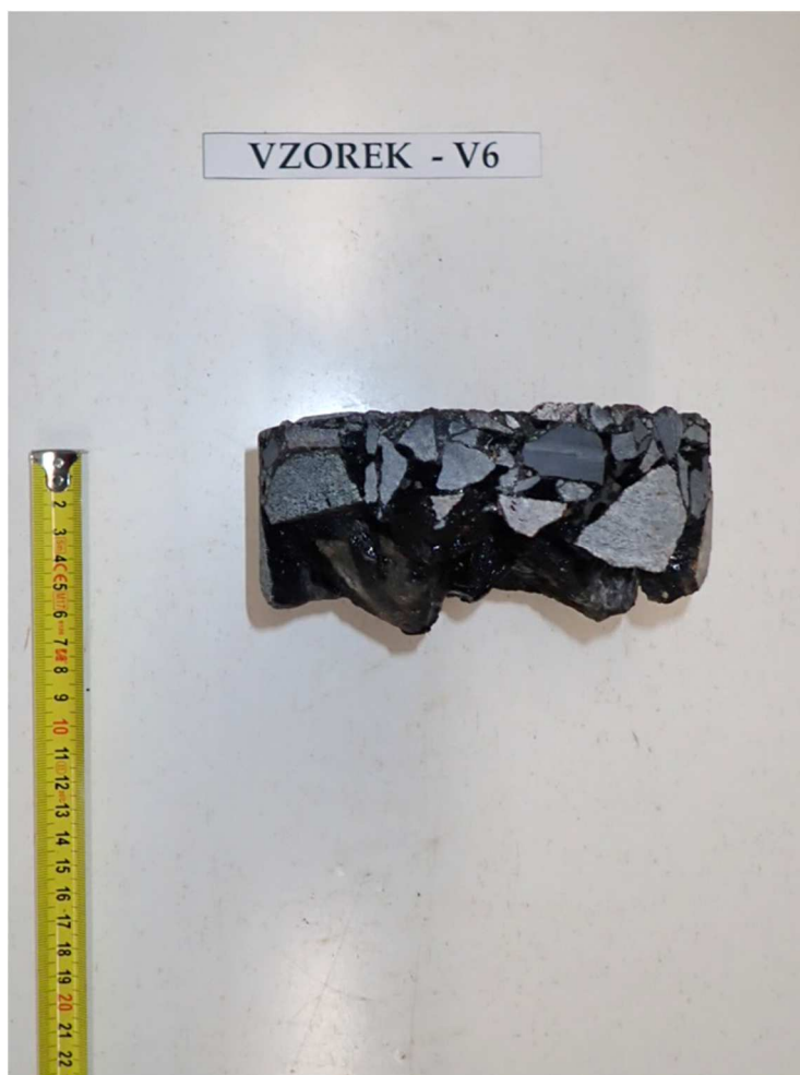
Obr. 12 - Jádru vývrtu Vzorek – V6 (laboratoř).
